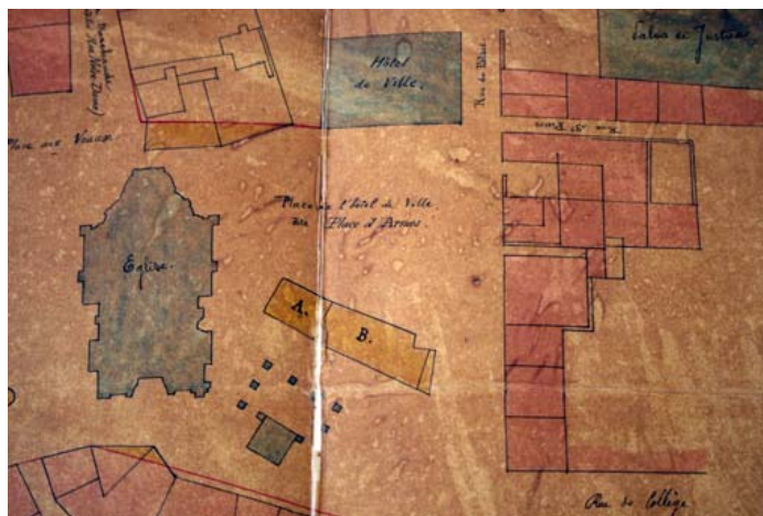
Mauriac. Archives départementales, 2 O 120/11. Plan de la place de l'hôtel de ville, 29 juin 1846 (en jaune, les bâtiments à démolir). Ce plan témoigne d'une volonté de faire dialoguer les deux édifices en composant un espace urbain régulier.
